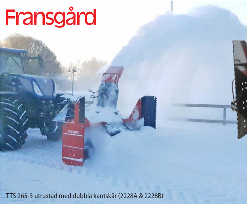
Hydrauliskt justerbar kantvinge med accumulator för TTS.
