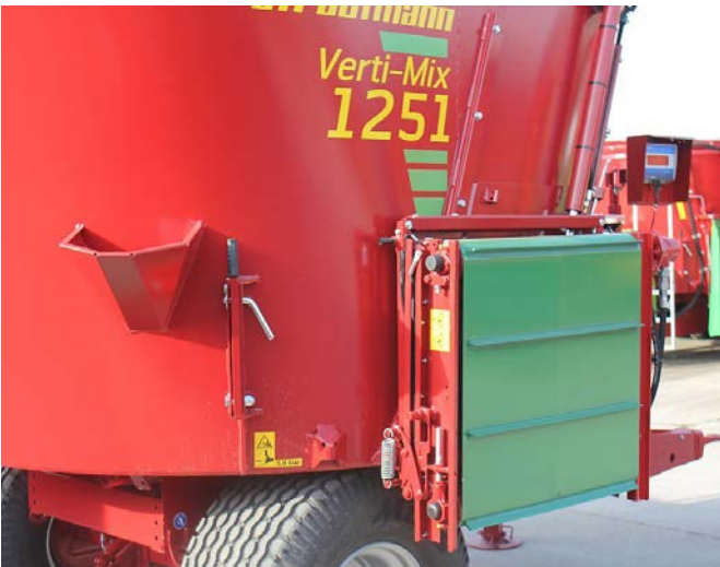
Elevator för sidolucka, ökar bredden med 30 cm
