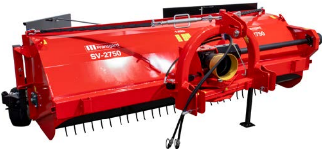
SV 2750 med hydraulisk vinkling.
