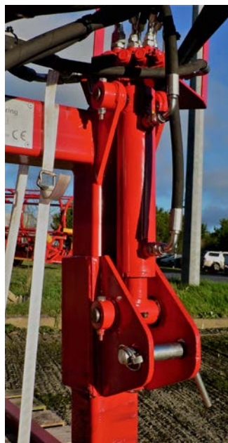
Hydrauliskt stödben för vinkling i sidled.
