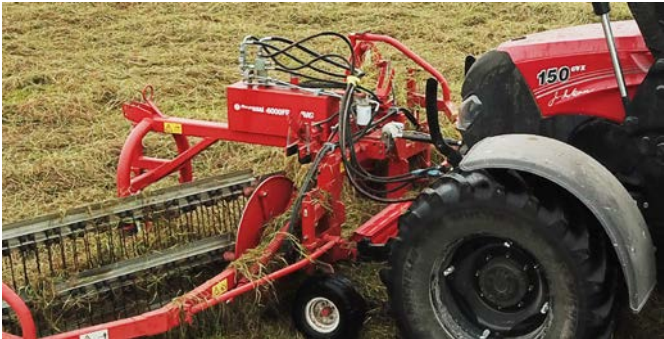
Frontrulle monterad mellan lyftarmarna för att undvika att gräs hänger sig under traktorn.
