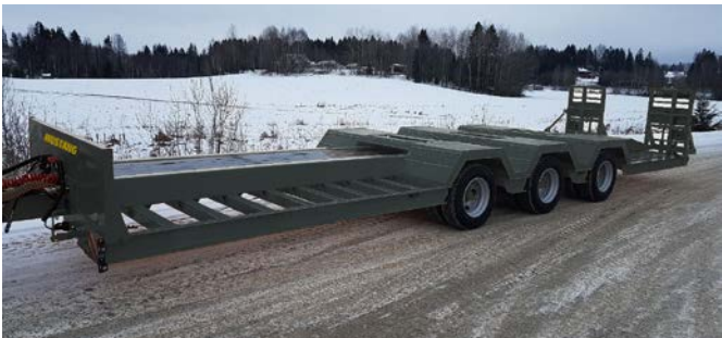
M-F modell lågbyggd för transport av skogsmaskiner.
