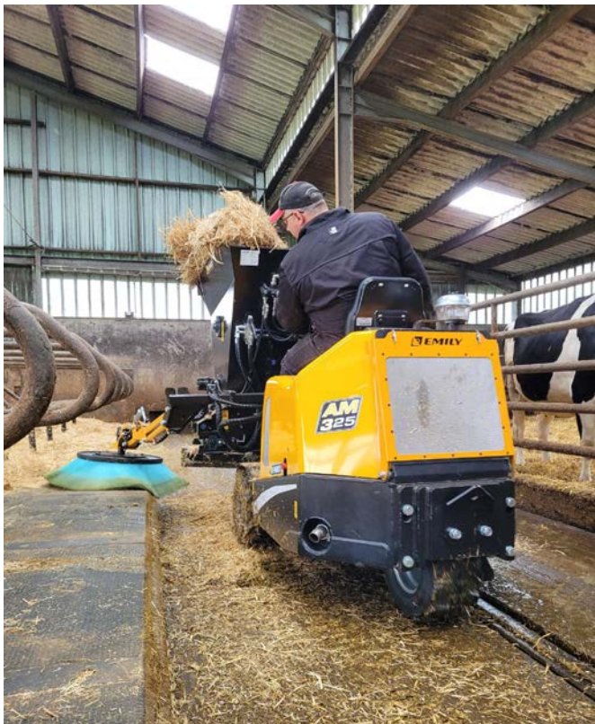
Redskapsbärare som borstar, strör och skrapar. Kan utrustas med funktionen att köra över 20 cm höga kanter.
