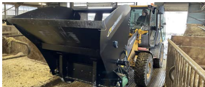
Redskapsbärare som borstar, strör och skrapar. Kan utrustas med funktionen att köra över 20 cm höga kanter.
