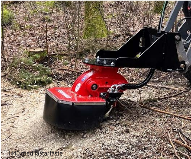
H40S med hydraulisk sväng
