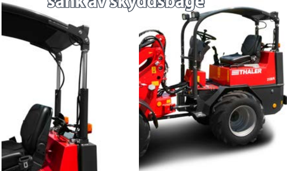
Tillvalsutrustning, hydrauliskt höj & sänkbar skyddsbåge, vilket gör maskinens höjd sänkbar med 25 cm. 2230 med 400/50-15 däck, ger en totalhöjd i sänkt läge, 195 cm. Andra däckdimensioner kan sänka totalhöjden ytterligare.
