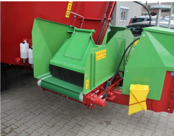
V-elevator höjer avlastningen med upp till 55 cm och sidoförskjutning på 25 cm. Lastar av åt höger och vänster sida.
