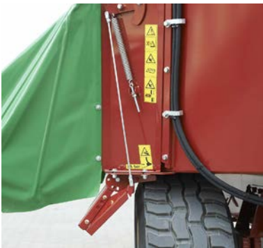
Mekanisk stös sammankopplad med luckan är standard.
