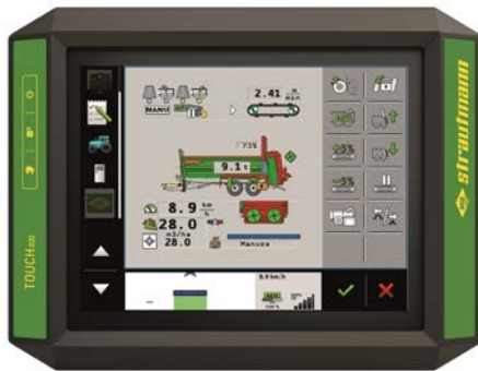
ISOBUS manöverdosa modell ME-Touch 800 med separat multifunktions handtag.
