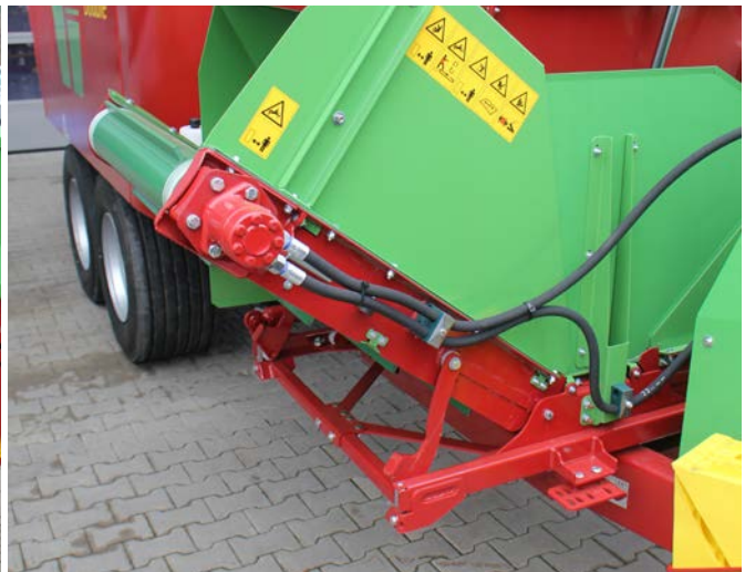
V-elevator höjer avlastningen med upp till 55 cm och sidoförskjutning på 25 cm. Lastar av åt höger och vänster sida.
