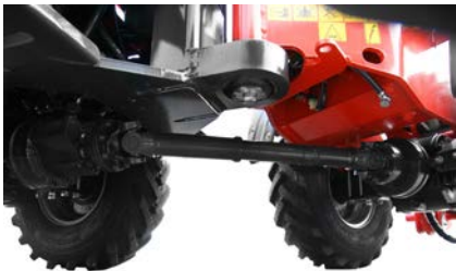
Kardanaxeldrivning på framaxel via högtrycksradialkolvmotor på 2230.
