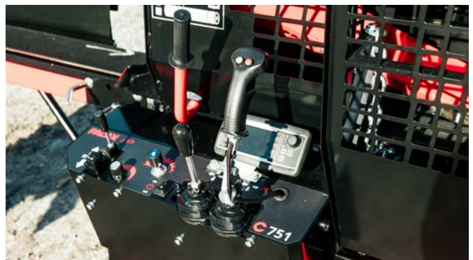
C751 Smart utrustad med hydraulstyrning för stockmatarbord.
