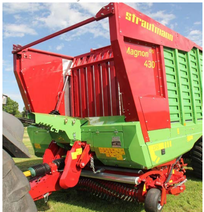
Hydraulisk frontstam för optimerad fyllningsgrad
