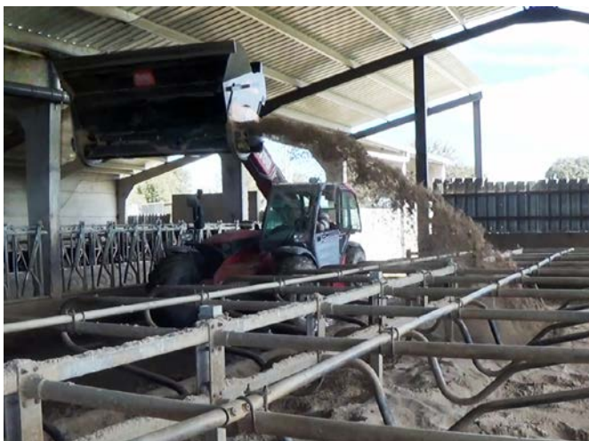
Multi'Dis sand, ströskopa anpassad för att även klara av att strö med sand.
