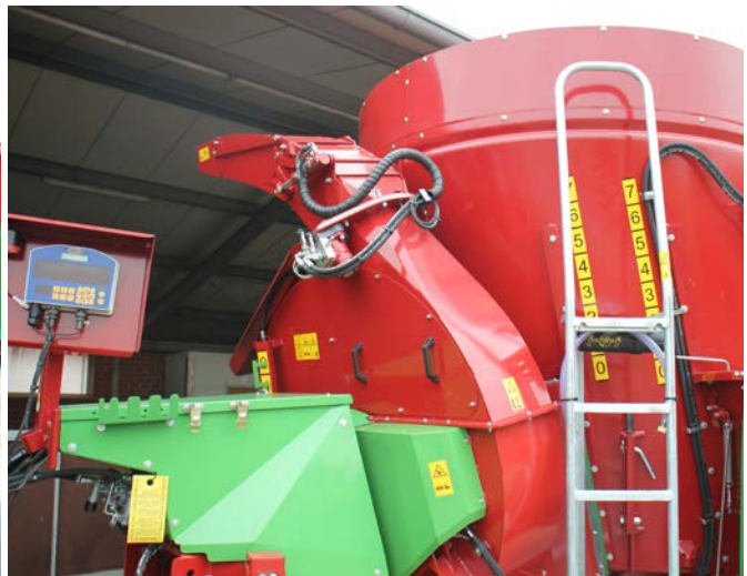
Mekanisk halmfläkt med svängbart utblås
