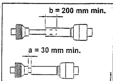
Kontrollér at kraftoverføringsakselen ikke kommer til å sitte i spenn når maskinen er løftet max og min. Vær oppmerksom på at i tilfeller hvor fresen er montert bak, kan traktoren kjøre høyere enn fresen. Vær også oppmerksom på at ved meget korte aksler kan vinkelen på akselen bli for stor, kontakt i såfall leverandør/importør.
